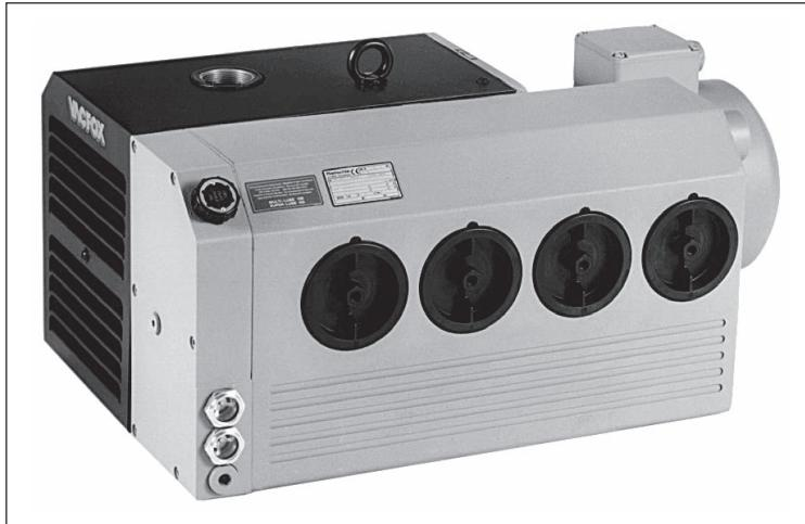
For at undgå kondensering af damp i pumpen er den som standard forsynet med gasballastventil med integreret kontraventil og mikrofinfilter. Ved befordring af større dampmængder kan pumperne leveres med større gasballastventil (ekstra udstyr).
